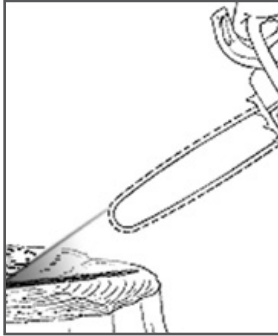
Рис. 9 Проверка смазки шины и цепи
